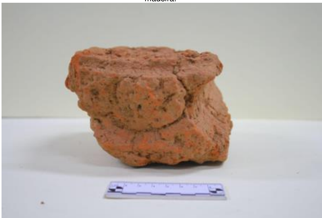
Figura 5 - Blocos de barro provenientes de parede de pau-a-pique com marcas de dedo e de madeira.
