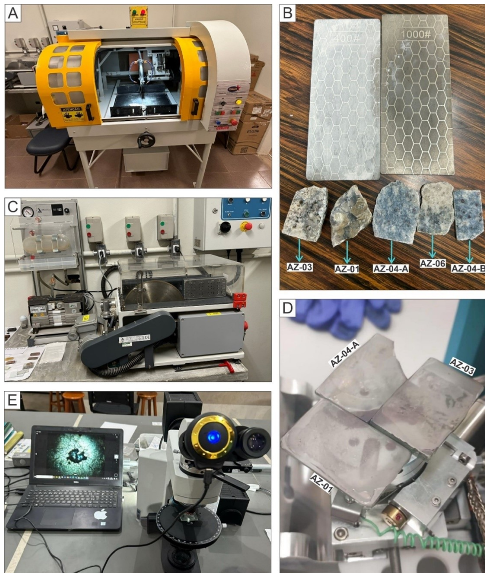
Figura 2: A) Serra utilizada para o corte das amostras. B) Placas diamantadas de 400# (mesh) e 1000# (mesh) utilizada para desbaste. Amostras cortadas para confecção das lâminas petrográficas. C) Serra para corte de precisão GTS-1 - Logitech. D) Lâminas no microscópio eletrônico de varredura (MEV). E) Visualização de lâmina no microscópio no Laboratório de Microscopia e Petrografia.
