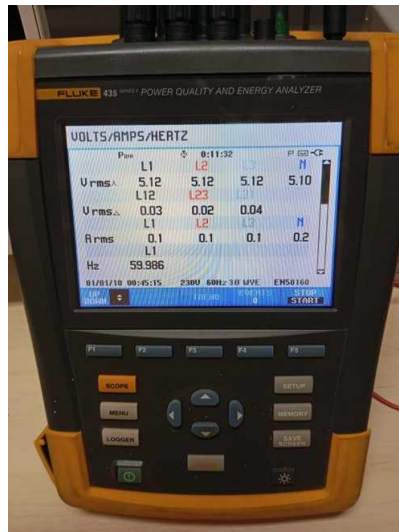
Figura 104 – Analisador de energia .
