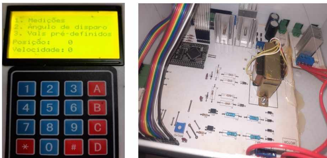
Figura 94 – Placa de controle construída conforme projeto.
