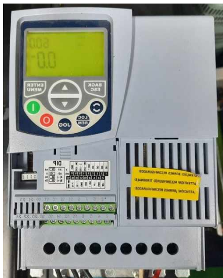
Figura 91 – Inversor de frequência CFW-09.
