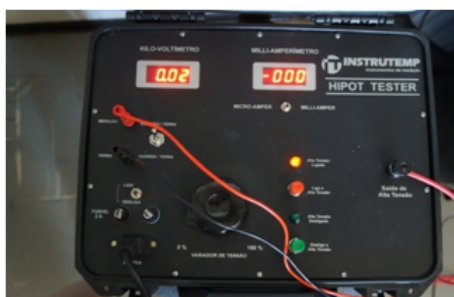
Figura 4.10: Fonte de alta tensão CC
