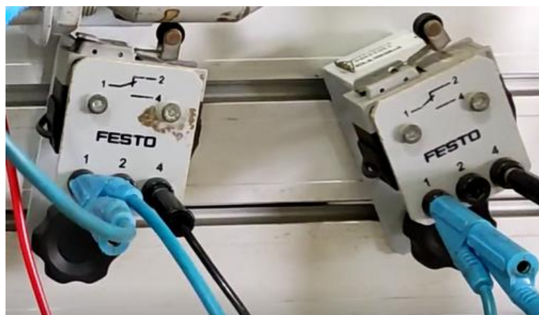
Figura 9 – Sensor de fim de curso com acionamento por rolete
