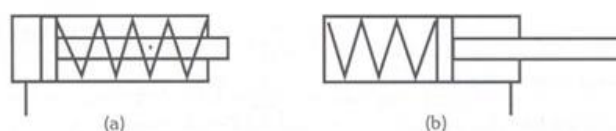
Figura 3.2 - Representação simbólica normalizada - (a) atuador linear de simples efeito normalmente retraído com retorno por mola - (b) atuador linear de simples efeito normalmente distendido com retorno por mola.
