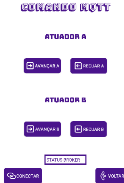
Figura 41 – Tela do aplicativo no modo de comando para dois atuadores
