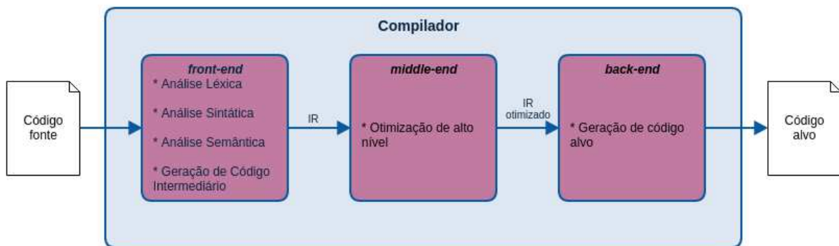
Figura 1 – Estrutura de um compilador otimizador.
