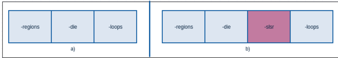
Figura 14 – Exemplo de mutação: inserção de um passo de otimização.
