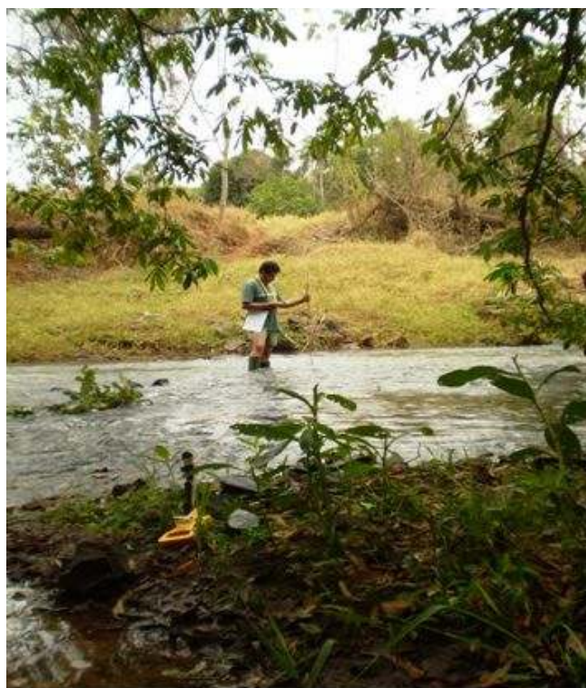
Figura 08. Funcionário da COPASA, medindo as vazões do Ribeirão Cachoeira de Cima utilizando molinete hidrológico.
