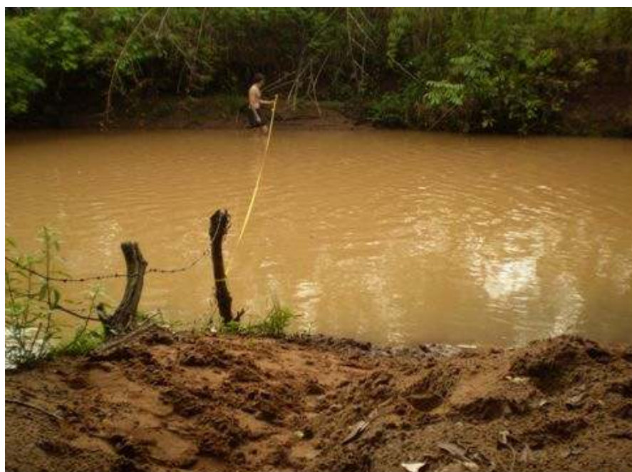
Figura 09. Medição da seção transversal do Ribeirão Cachoeira de Cima para cálculo de vazão.
