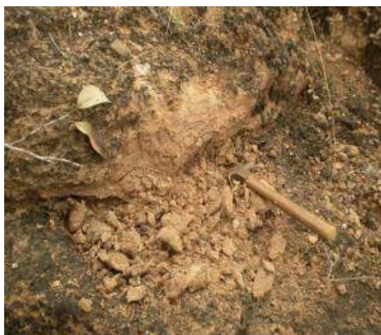
Figuras 15 e 16. Amostras das principais litologias encontradas na Serra dos Talhados e Chapadão dos Queirós: a esquerda, arenito de granulação grosseira em estágio de intemperismo e a direita argilito de granulação média/fina. Ambos dão origem a solos com alto teor de areias.
