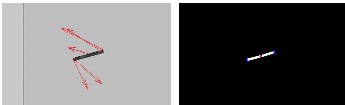
Figura 23 - Drone segmentado (à esq.) e a localização do centroide (à dir.) no ambiente interno
