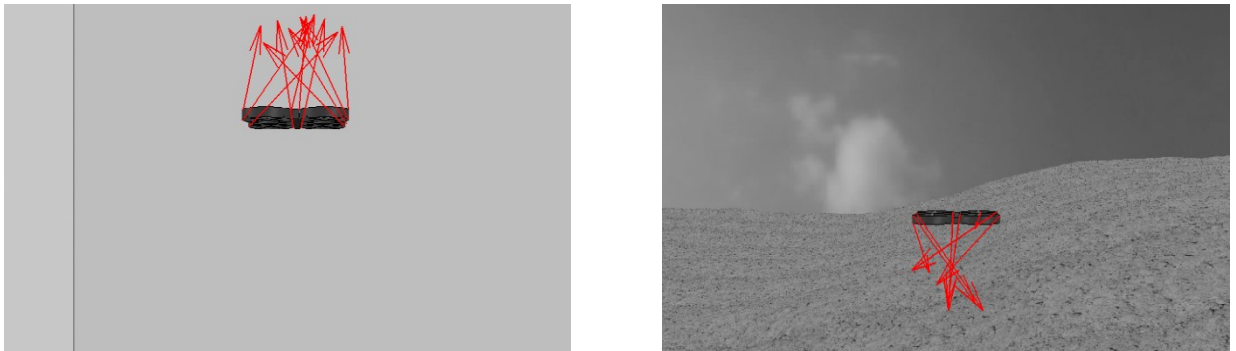
Figura 19 - Vetores segmentando o drone através do algoritmo de Lucas-Kanade. Ambiente interno (esq.) e ambiente externo (dir.)
