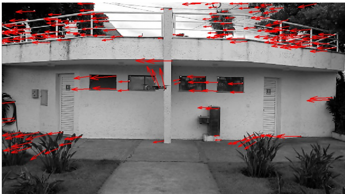
Figura 20 - Ruído na segmentação utilizando a técnica de fluxo óptico de Lucas e Kanade
