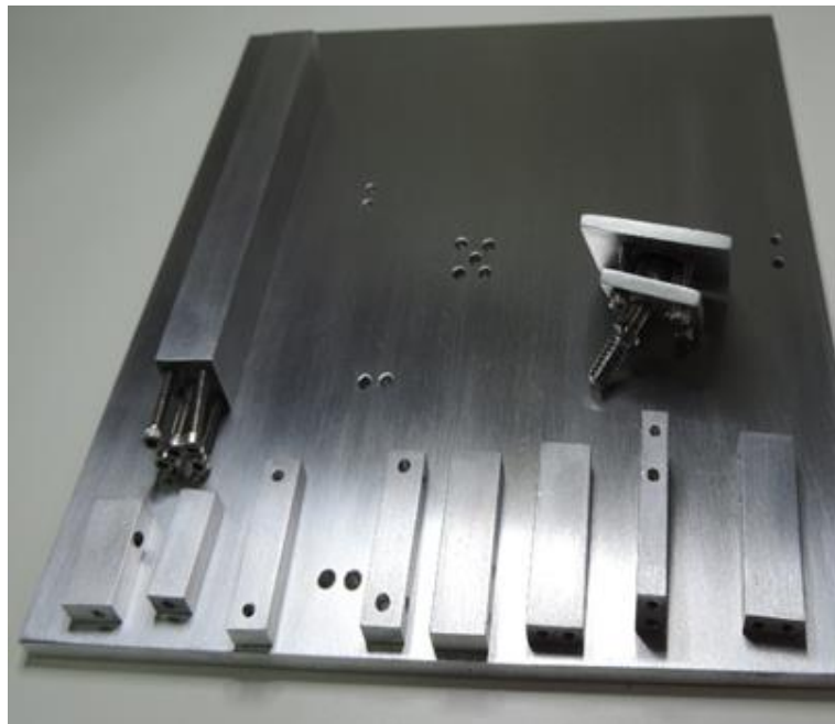
Figura 28 - Peças do sistema Ball and Plate , cortadas e furadas.
