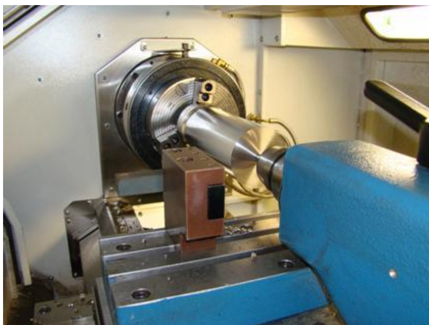
Figura 3.13 – Fixação das barras entre placa e ponta para os ensaios de torneamento longitudinal
