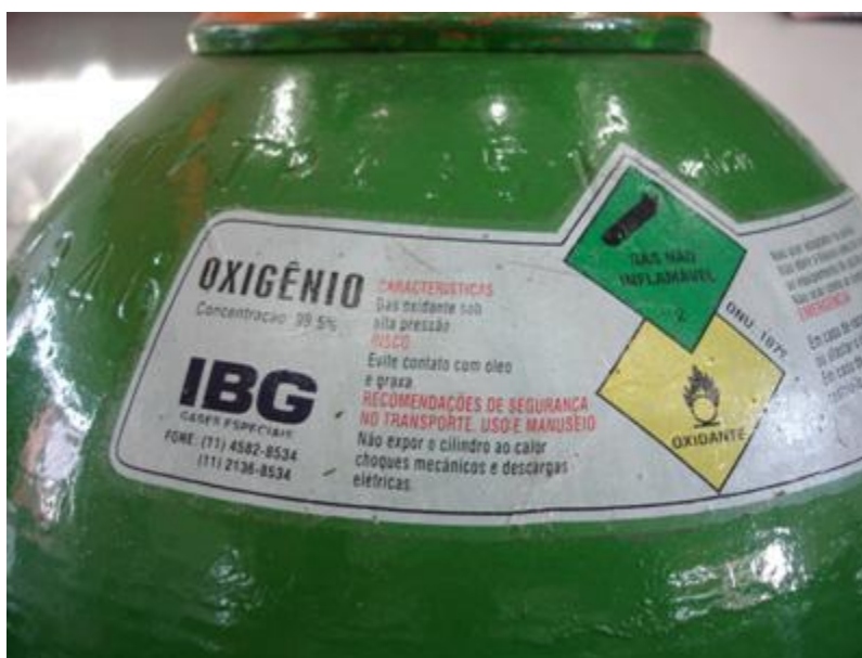
Figura 3.9 – O_2 para criação de atmosfera oxidante
