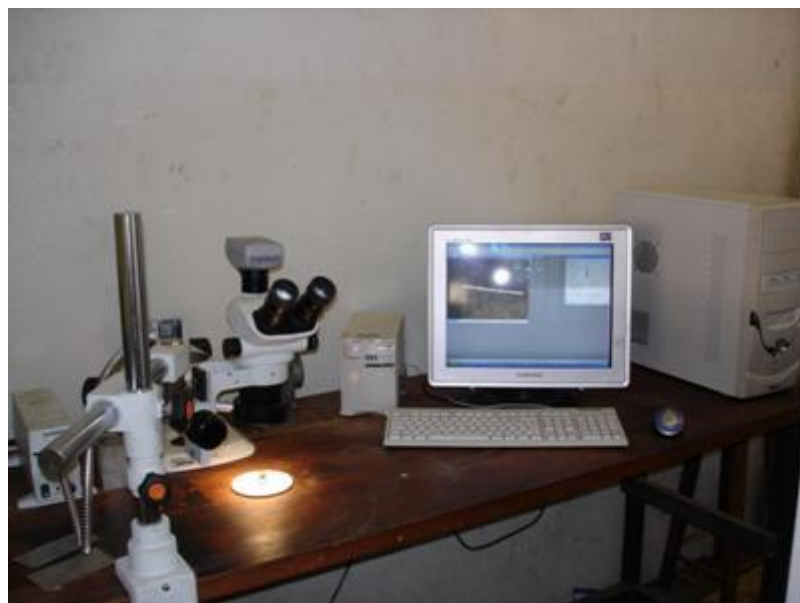
Figura 3.3 - Estereomicroscópio utilizado para medição dos desgastes das ferramentas
