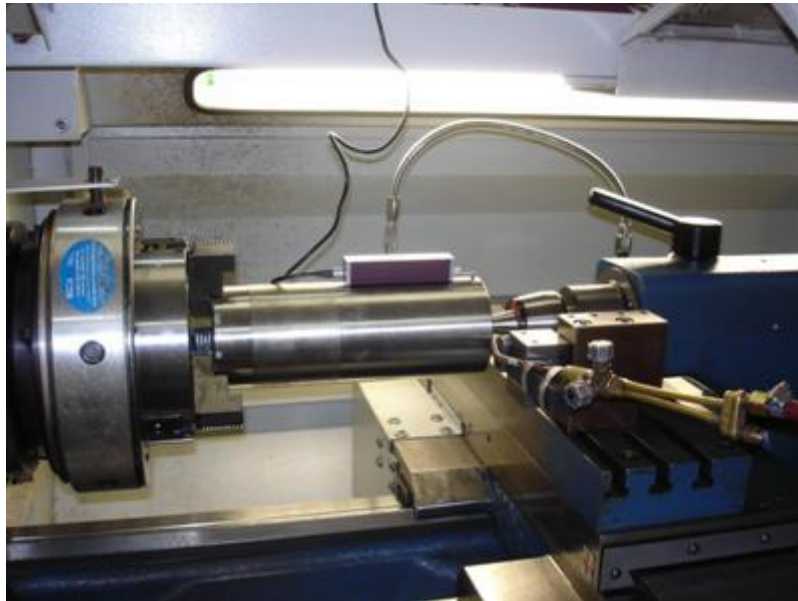
Figura 3.4 – Medição da rugosidade superficial na peça montada
