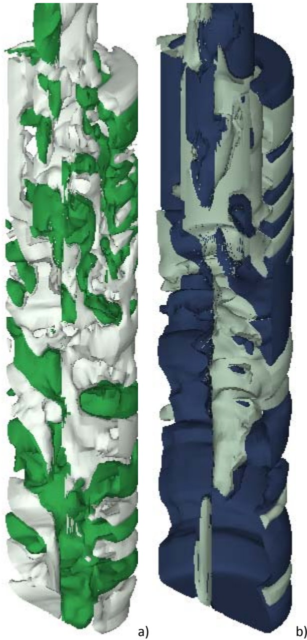
Figura 82: Isovalores de velocidade radial. (a) Corte em Y=0 do campo instantâneo obtido com o modelo de Yakhot, verde 0,075 m/s, branco -0,075 m/s. (b) Corte em Y=0 do campo médio obtido com o modelo de Smagorinsky cinza 0,01 m/s, azul -0,01 m/s
