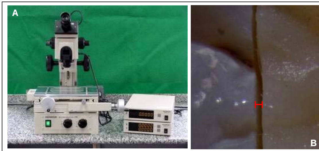
Figura 7. A. Estereomicroscópio empregado na medição da adaptação marginal, Olympus; B. Medição da adaptação marginal.
