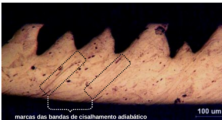
Figura 4.52 – Micrografia dos cavacos de aço inoxidável austenítico ABNT 316UF obtidos para a usinagem a seco.
