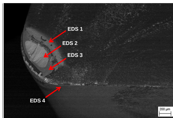
Figura 4.45 – Ferramenta utilizada com aplicação de fluido de corte com 15 MPa e concentração de 10 %.
