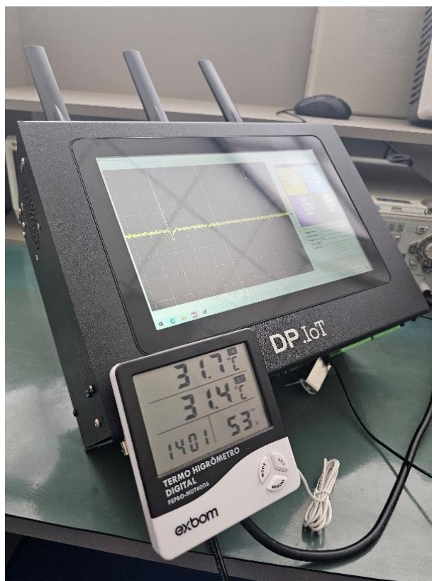
Figura 59 – Arranjo de teste de estresse
