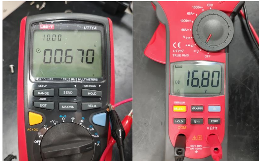
Figura 52 – Verificação da tensão e corrente durante
