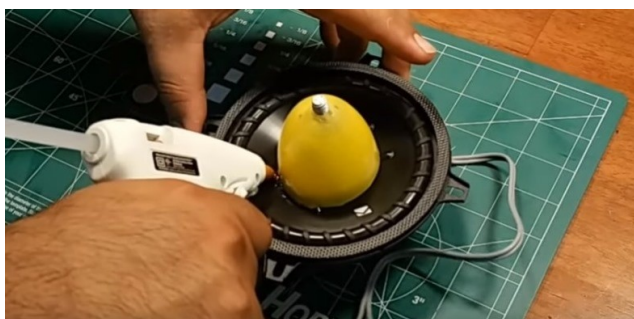
Figura 5.8 – Adaptação para isolamento das vibrações do alto-falante.
