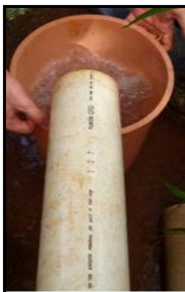
Figura 3 - Coleta de vazão em área de Voçoroca. Autor: PEREIRA, 2012
