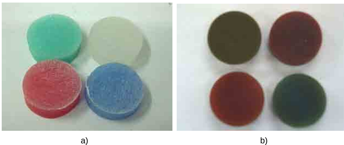
Figura 4.66 – Amostras envelhecidas em petróleo: a) antes do envelhecimento; b) depois do envelhecimento.
