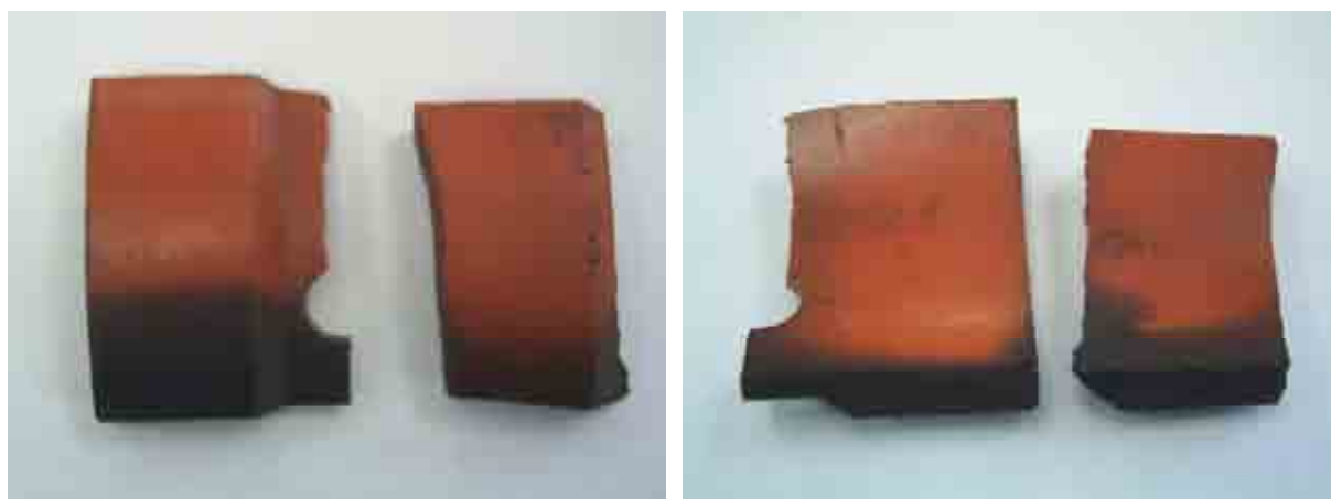
Figura 4.65 – Poliuretano de referência 1: a) Retirado do fundo do mar; b) Envelhecido em Petróleo.
