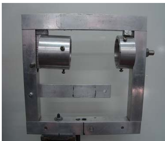
Figura 4.4 - Suporte projetado para avaliar a estabilidade do conjunto.
