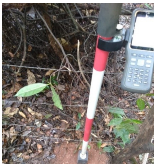
Figura 16 – Fotos do levantamento nos vértices da cerca paraguaia.
