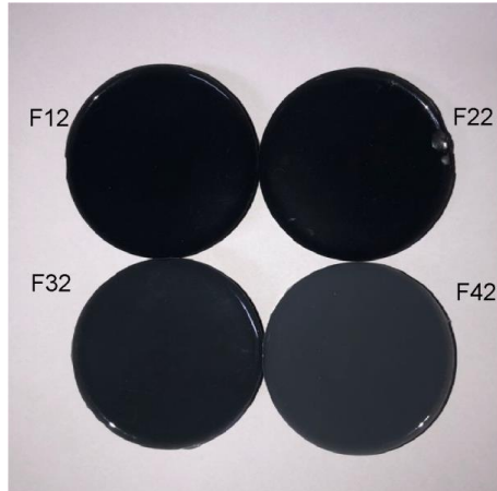
Figura 13: Fantomas de forma grande de dimensões aproximadas de (5,9 x 10,5) cm para serem analisados no SFDI.
