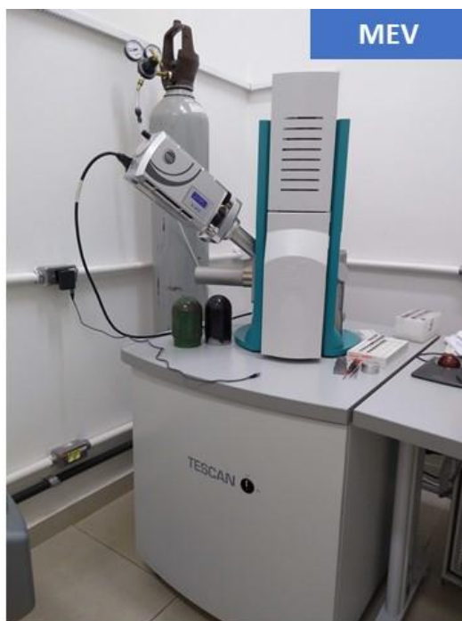
Figura 8: Microscópio Eletrônico de Varredura utilizado para a captura das fotos (IQ-UFU).
