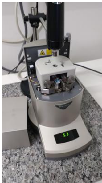
Figura 8. Microscópio de Força Atômica, Shimadzu para análises morfológicas da superfície do eletrodo.
