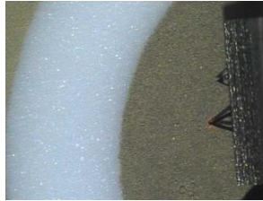
Figura 10: Cantilever do AFM sobre o eletrodo de ouro (DS BT220).
