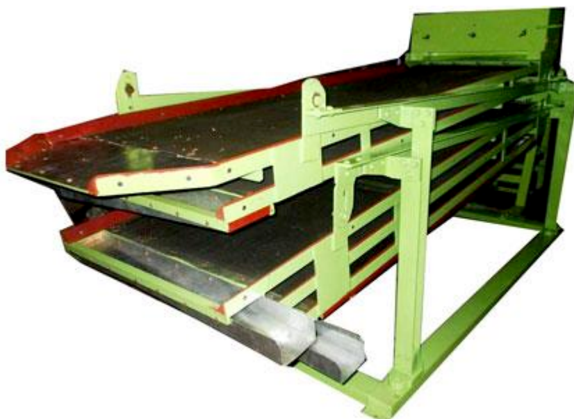
Figura 15 – Separador utilizado na produção de chá preto.
