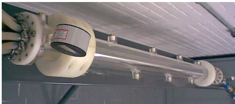
Figura 5.4: Seção anular horizontal com bocais utilizados para a leitura dos gradientes de pressão.
