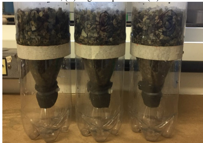
Figura 8 - Registro fotográfico das colunas contendo os materiais: (A) Zeólita; (B) Escória de Alto Forno; (C) Argila Expandida e (D) RCC
