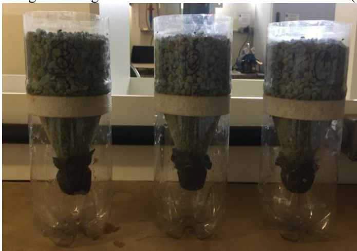
Figura 8 - Registro fotográfico das colunas contendo os materiais: (A) Zeólita; (B) Escória de Alto Forno; (C) Argila Expandida e (D) RCC
