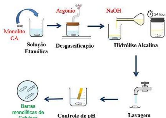
Figura 6. Esquema de conversão dos monolitos de acetato em celulose em monolitos de celulose.
