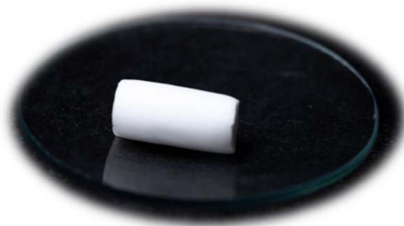
Figura 14. Fotografia de um monolito de acetato de celulose produzido neste trabalho com dimensões de aproximadamente 10 mm de comprimento por 5 mm de diâmetro.
