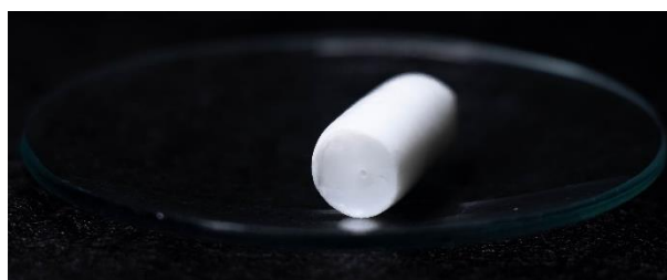
Figura 16. Fotografia de um monolito de celulose obtido após a desacetilação do monolito de acetato de celulose.
