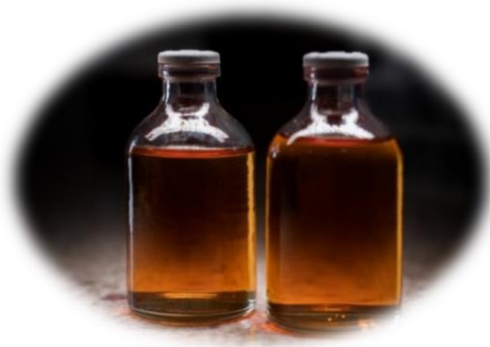
Figura 24. Imagem dos frascos contendo o oleato de metila obtido após o processo de purificação com lavagem com água e remoção de umidade.
