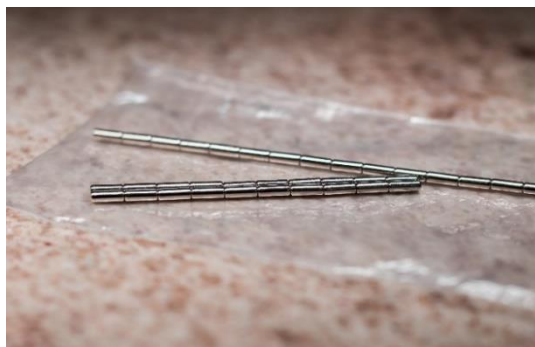
Figura 7. Ímãs de neodímio cilíndricos com 8 mm de comprimento por 3 mm de diâmetro.
