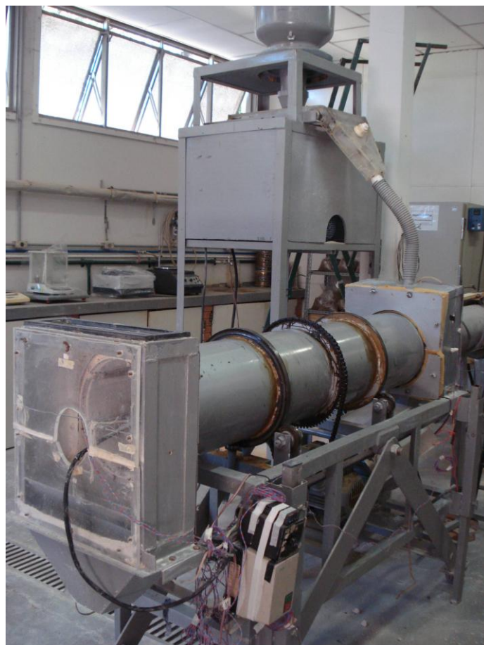
Figura 3.3 - Fotografia do secador rotatório convencional concorrente utilizado.
