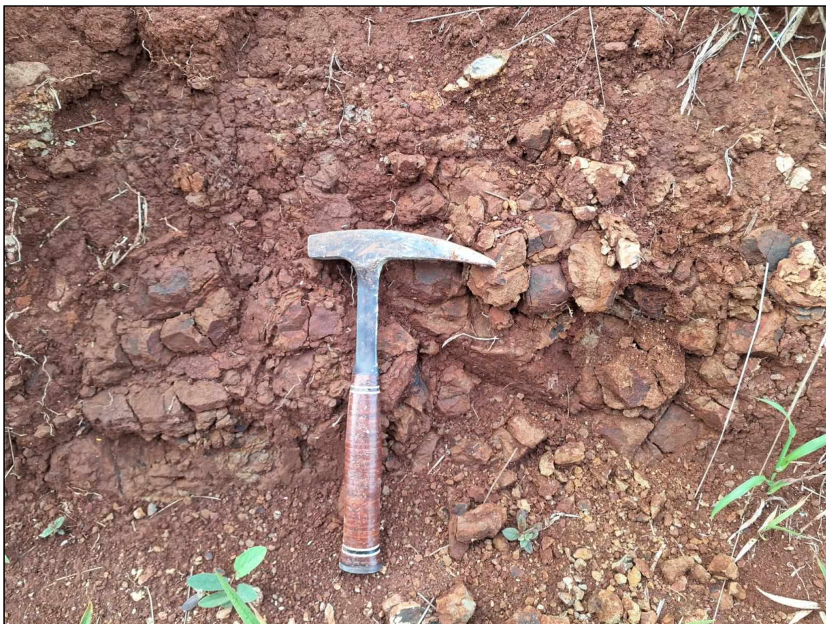
Figura 5 - Basalto intensamente alterado, apresentando estrutura friável e solo residual de coloração avermelhada, típico dos processos de intemperismo
