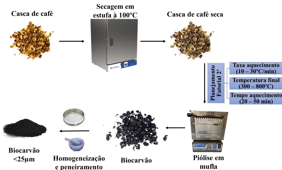
Figura 6 - Representação esquemática das etapas e processos envolvidos na produção dos diferentes biocarvões conforme planejamento fatorial 2^3 .
