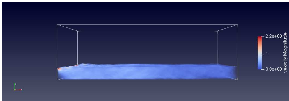
Figura 4.9 – Momento em que há impacto de fluido pela segunda vez na parede vertical esquerda em t = 5,62 \text{ s} .
