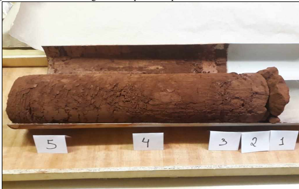
Figura 21: Coluna estratigráfica do primeiro ponto com as camadas identificadas
