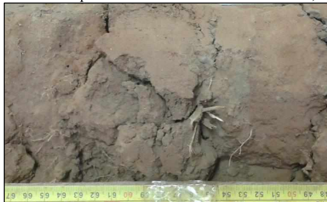
Figura 08: Raízes identificadas em camada do testemunho. Exemplo da camada um do testemunho coletado próximo aos bairros Nova Ituiutaba I, II, III e IV.
