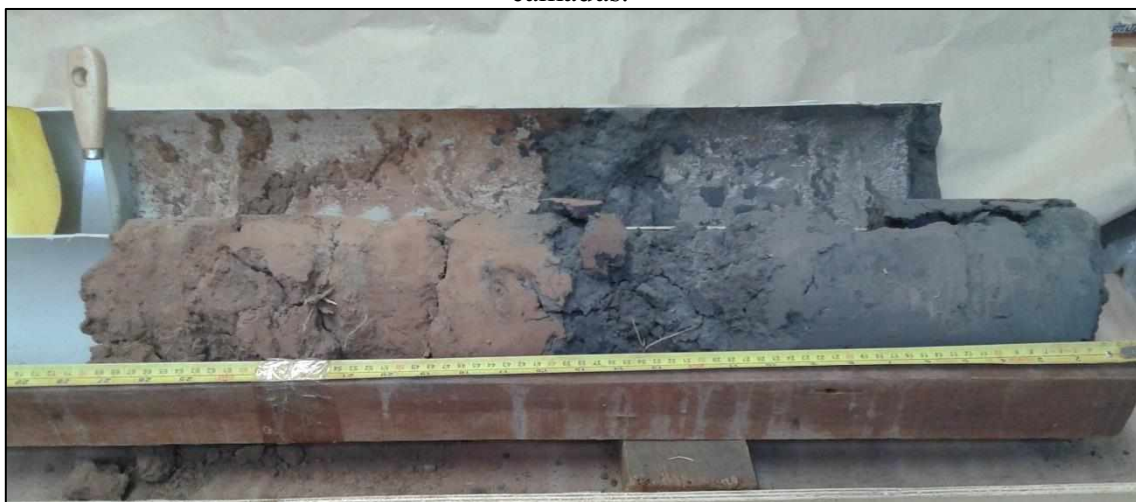
Figura 06: Medição da espessura do testemunho de um depósito tecnogênicos e suas camadas.
