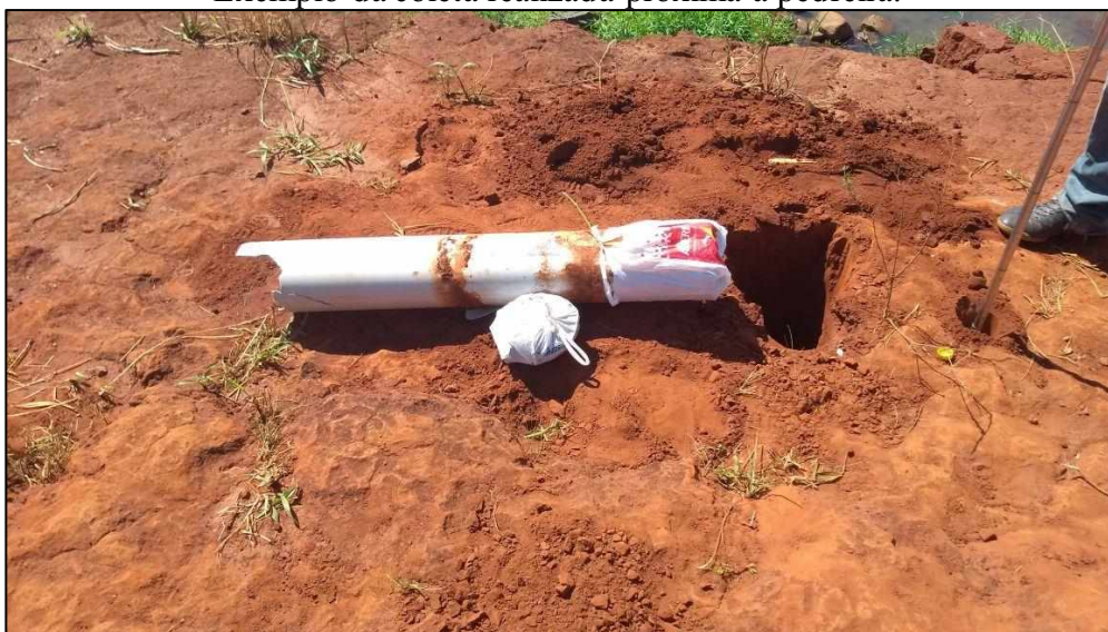
Figura 04: Tubo de PVC com o testemunho do depósito tecnogênicos. Perceba que a parte superior do tubo foi danificada, devido as marretadas que ajudaram na penetração. Exemplo da coleta realizada próxima a pedreira.
