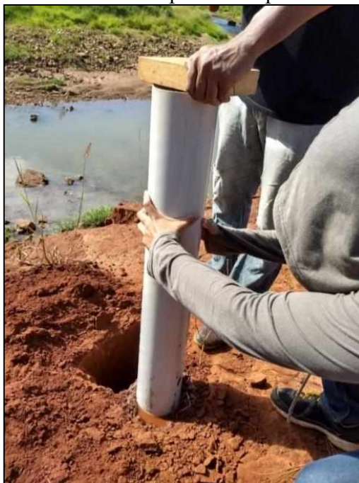
Figura 03: Introdução do tubo PVC no solo para retirada do testemunho. Exemplo da coleta realizada próxima a pedreira.
