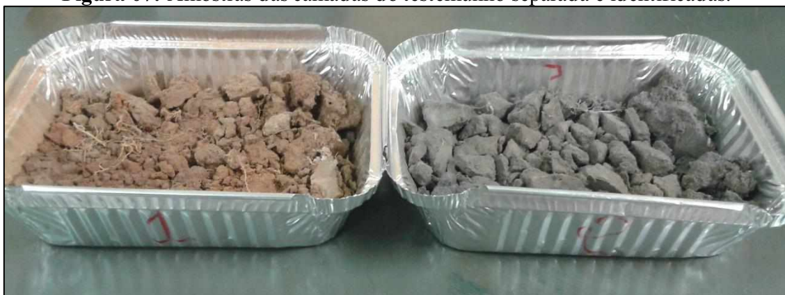
Figura 07: Amostras das camadas do testemunho separada e identificadas.
