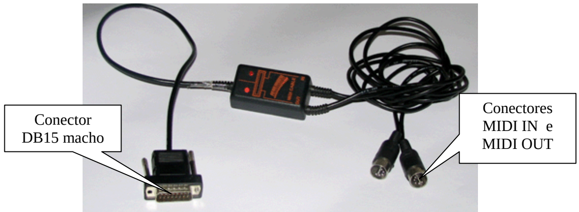
Figura 2.11 – Cabo MIDI padrão MPU401 com conexão DB15
