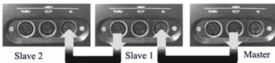
Figura 2.7 – Conectores e conexões MIDI IN, MIDI OUT E MIDI THRU
