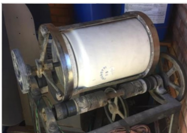
Figura 3.1-1 – Moinho de bolas utilizado na cominuição do material particulado.
