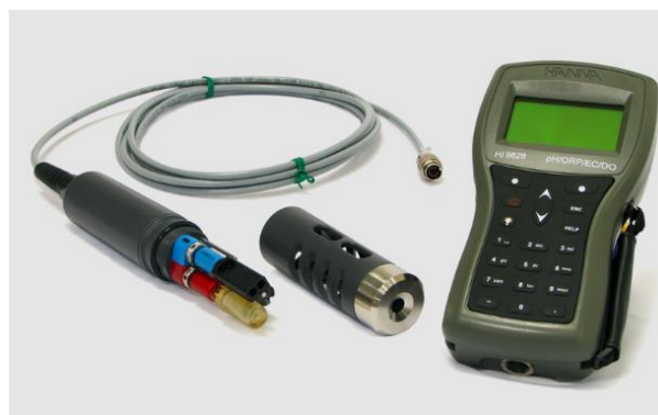
Figura 7: Multiparâmetro Hanna® HI9829 utilizado nas medições.
