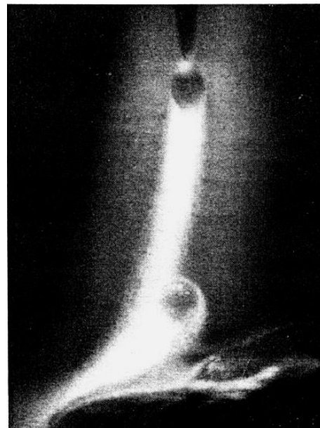
Figura 2.19 - Fotografia de soldagem Plasma-MIG com eletrodos na polaridade positiva. Corrente Plasma de 110 A à 49V e corrente MIG/MAG de 150A à 29V. Arame de aço inoxidável de 1,2 mm. (ESSERS; JELMORINI; TICHELAAR, 1972).
