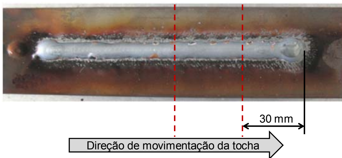
Figura 5.1 – Fotografia da superfície da chapa referente ao Teste 5.6, com indicação da direção de soldagem e das regiões onde foram realizadas as seções transversais.
