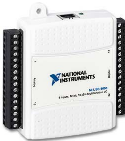
Figura 3.15 - Placa de aquisição tipo “Plug and Play” da National Instruments modelo: NI USB-6009.
