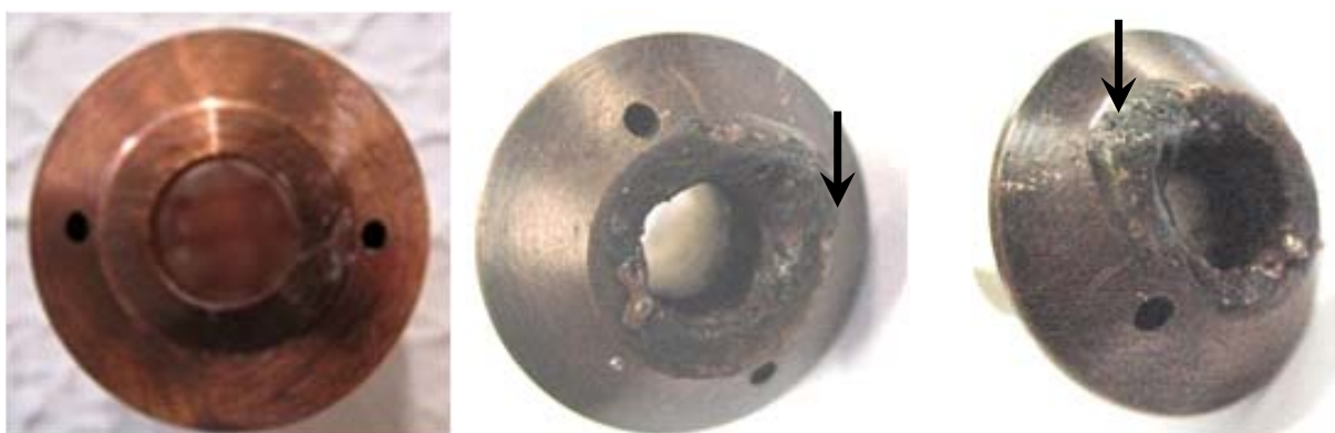
Figura 4.5 – Aspecto de um eletrodo Plasma danificado por deficiência na refrigeração. Da esquerda para direita, eletrodo Plasma antes e após uma seqüência de seis cordões com 160 A de corrente pelo circuito Plasma.
