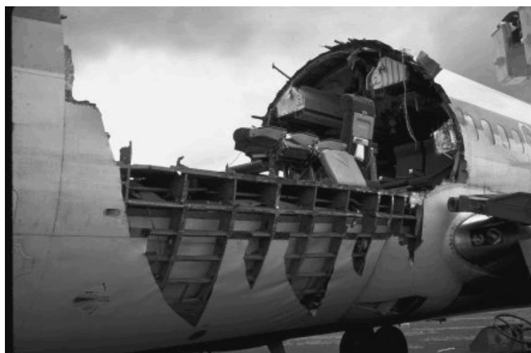
Figura 1.1 - Separação da fuselagem do avião da Aloha Airlines em 1988, (FARRAR; LIEVEN; BEMENT, 2005).
