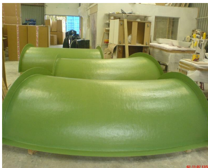
Figura 11 – Fôrma em fibra de vidro. Fonte: Morikawa (2003)
