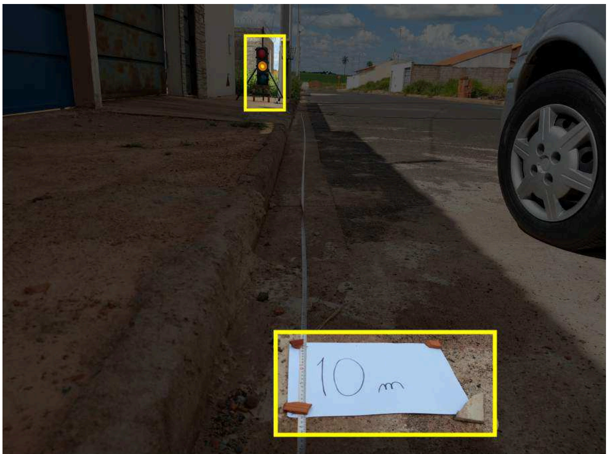
Figura 17 – Teste de 10 metros, com antena, ambiente aberto.
