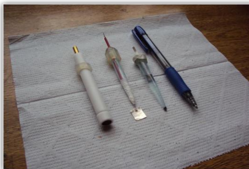
Figura 3.2: Eletrodo de grafite conectado a base, eletrodo auxiliar de platina e eletrodo de referência Ag/AgCl, comparados a uma caneta esferográfica.
