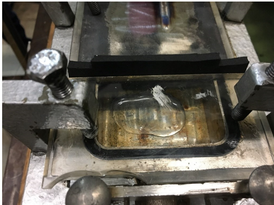
Figura 3.3 – Bolha de ar retido dentro do calorímetro.
