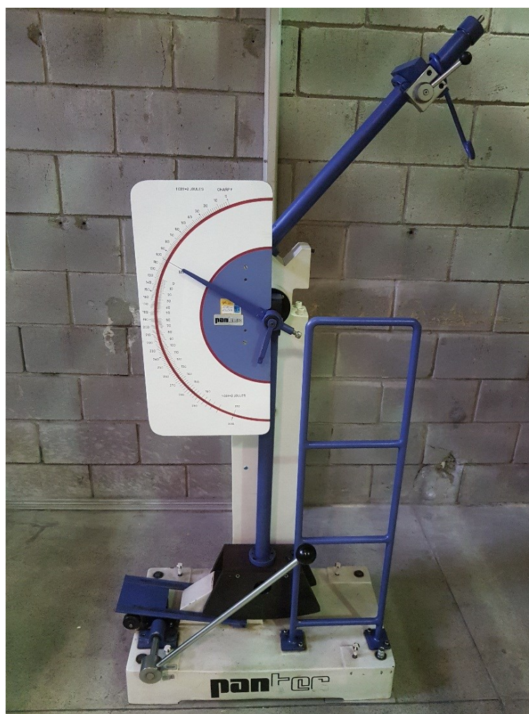
Figura 3.11 – Máquina de ensaio de impacto Charpy para corpos de prova convencionais, da marca PANTEC e com capacidade de 300 J.
