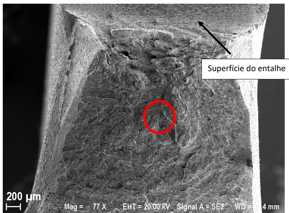
Figura 3.18 – Vista geral da superfície da fratura de um ensaio de impacto Charpy de um corpo de prova de seção 3 x 4 mm 2 , indicando a região de análise escolhida.
