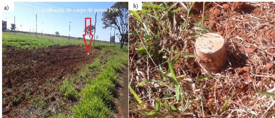
Figura 6 – Área trabalhada por trator (a). Estado de abalo do corpo de prova P09 (b).
