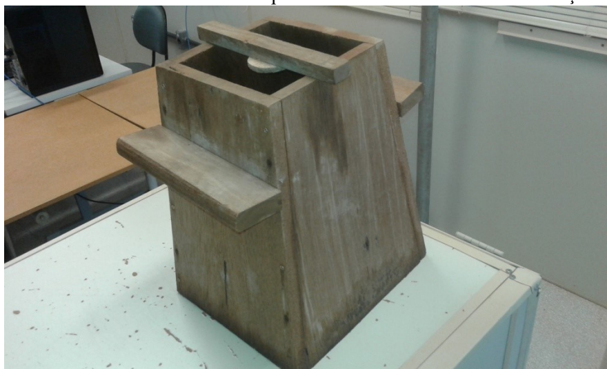
Figura 10 – Forma de madeira feita com o padrão do IBGE utilizada na construção dos marcos.
