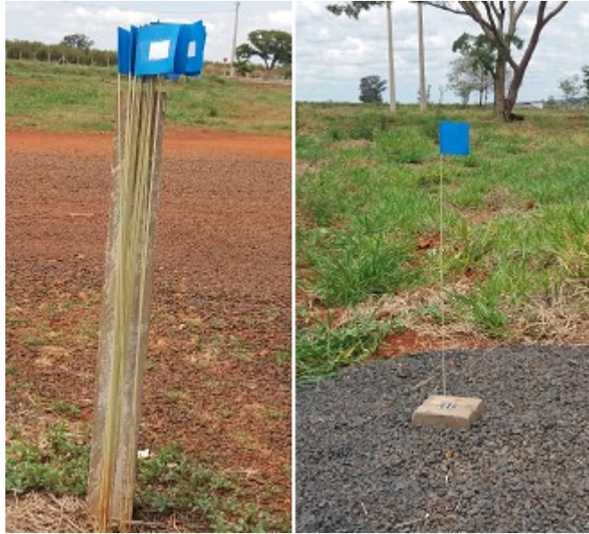
Figura 31 – Bandeiras utilizadas e colocação de brita ao redor do marco.
