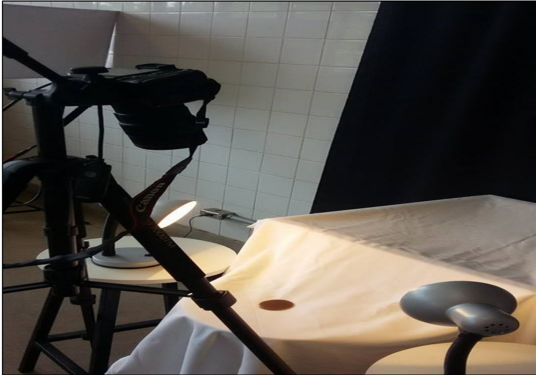
FIG.3 – FOTOGRAFIA DOS CORPOS DE PROVA EM ESTÚDIO COM ILUMINAÇÃO PADRÃO.
