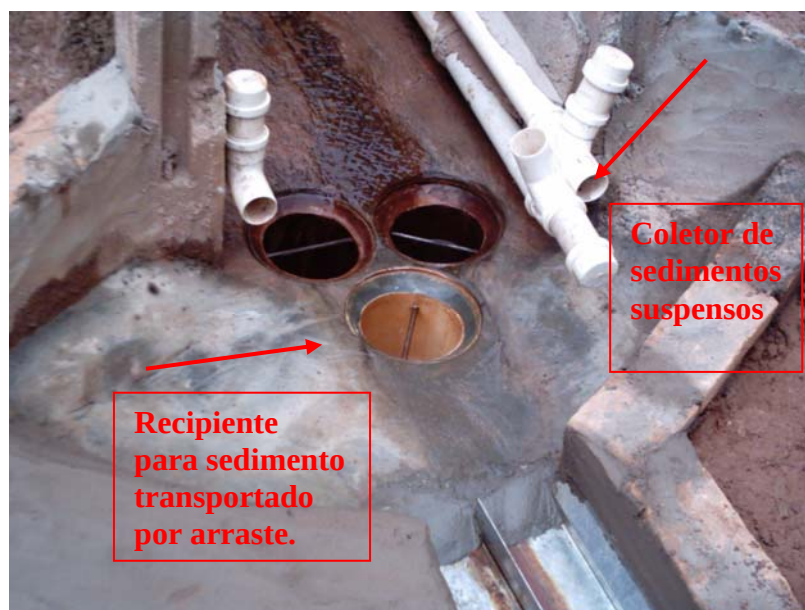
Fig. 36. Dispositivos usado para a coleta de sedimentos Autor: ROCHA, E. A. V., mar. / 2005.
