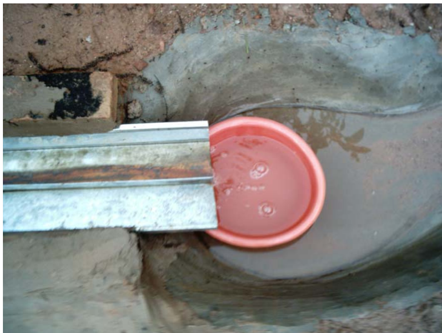
Fig. 8 – Técnica utilizada para medição da variação da vazão. Autor: ROCHA, E. A. V., mar. /2005.
