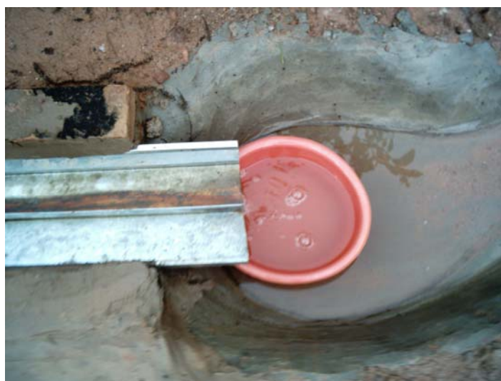
Fig 37 – Determinação da vazão. Autor: ROCHA, E. A. V., mar. / 2005.
