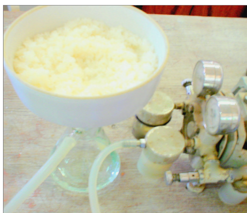
Figura 3.11 – Vista do sistema de filtração dos cristais.
