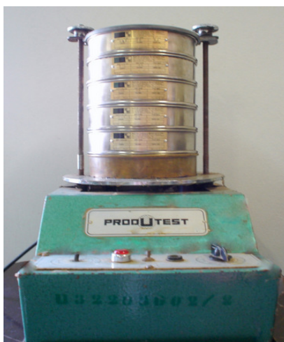
Figura 3.14 – Aparato utilizado na quantificação por peneiramento.
