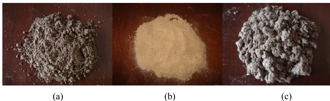
Figura 3.6 - (a) linter hidrolisado; (b) linter neutralizado; e (c) linter mecânico.
