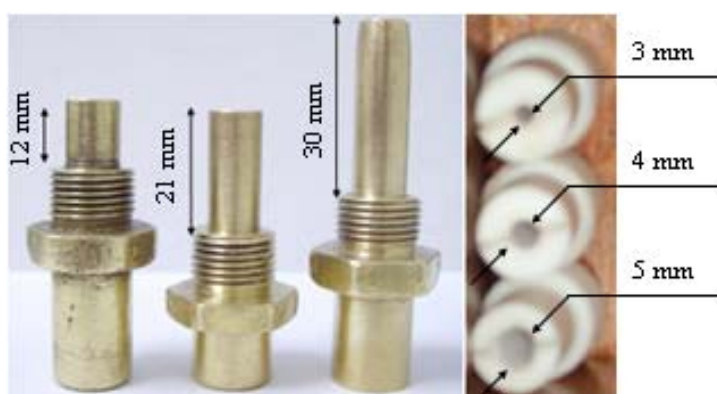
Figura 3.2 – Foto dos diferentes comprimentos de vortex finder (12, 21 e 30 mm) e diâmetros de underflow (3, 4 e 5 mm) utilizados para os hidrociclones HF 11 e HC 11 .
