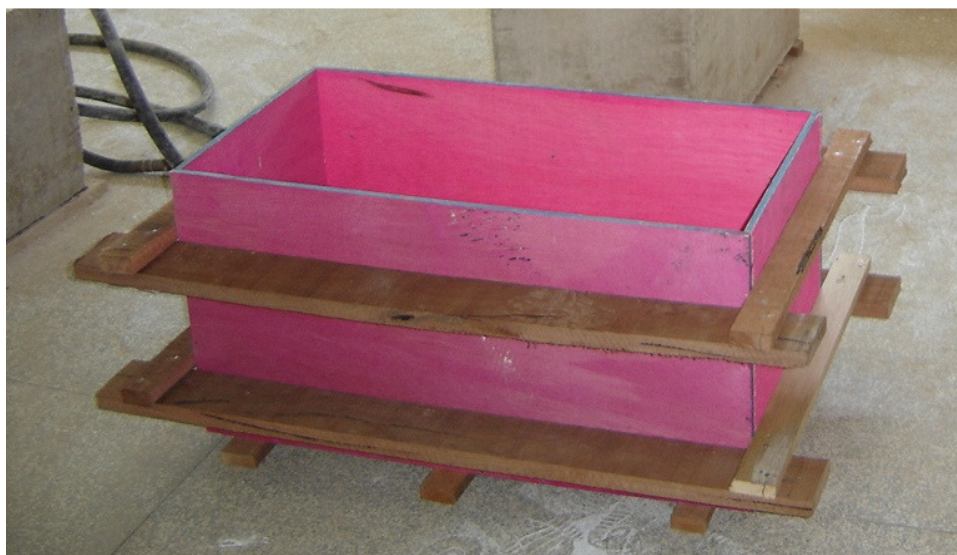
Figura 6.8 – Fôrma para moldagem dos blocos
