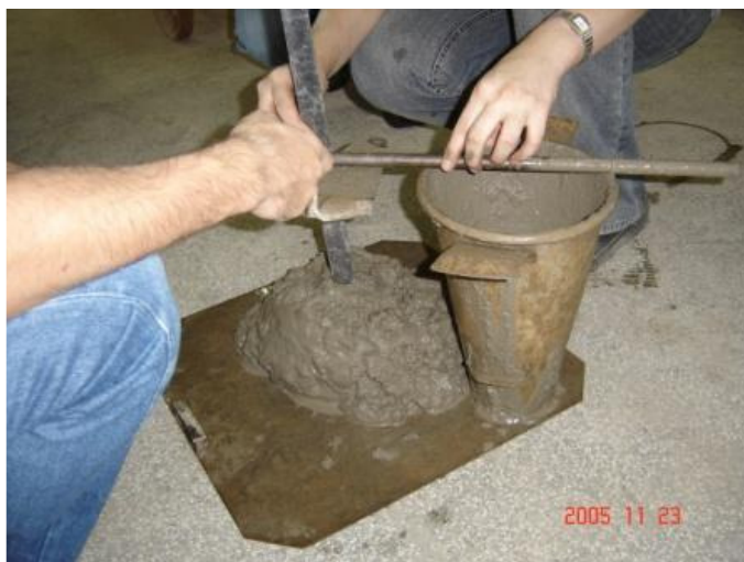
Figura 6.7 – Determinação da consistência pelo abatimento do tronco de cone - Traço A - Britas 1e 2.
