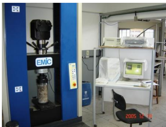
Figura 6.23 – Rompimento de corpo-de-prova
