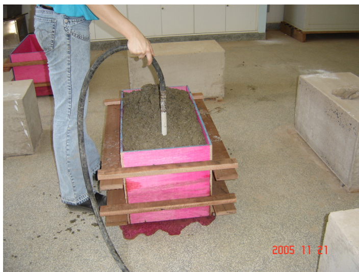
Figura 6.11 – Adensamento dos blocos
