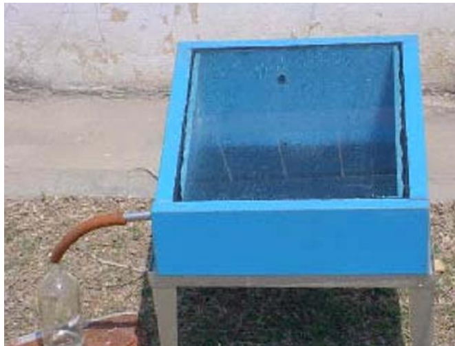
Figura 2.11 – Destilador solar de fibra de vidro-bacia plano retangular. Fonte: Fonseca (2005)
