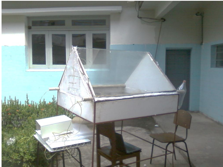
Figura 3.7 – Dessalinizador Solar Simétrico Parabólico Composto ( 45^\circ e 45^\circ ). Fonte:: Lopes (2013)
