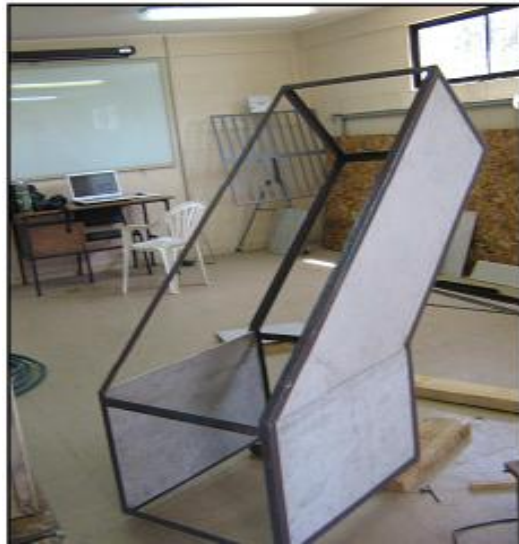
Figura 2.16 – Dessorizador Solar etapas de construção Fonte: Vicente (2009).
