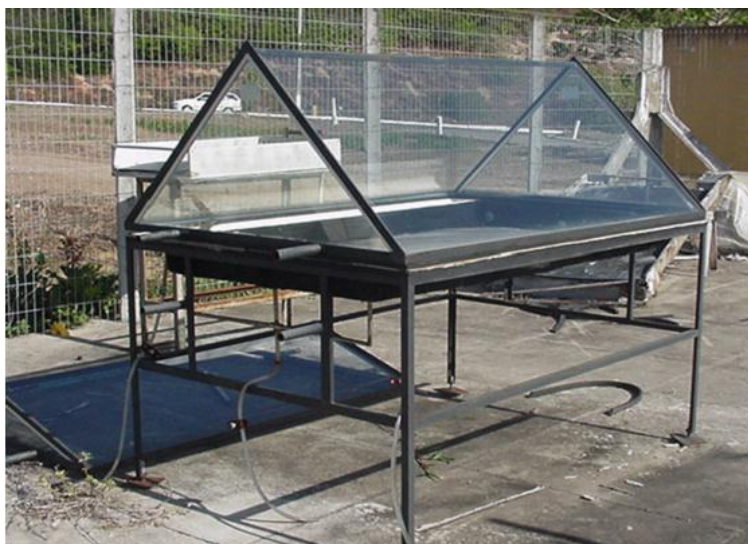
Figura 2.9 – Destilador solar com cobertura de 45° Fonte: Bezerra et al, (2004).
