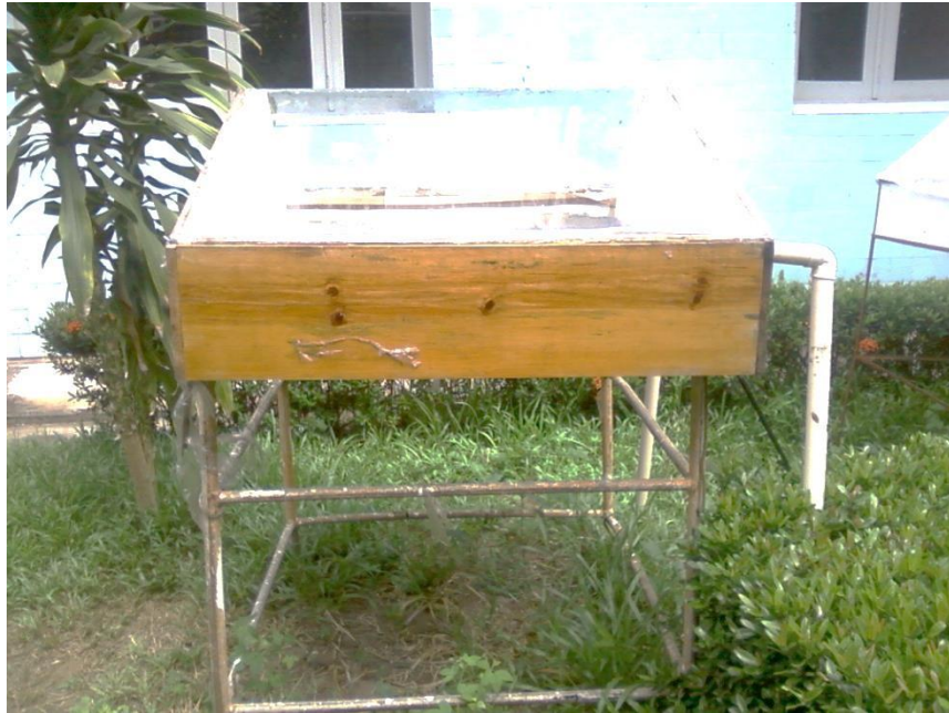
Figura 3.4 – Dessalinizador Solar Assimétrico Parabólico Composto (20° e 45°). Fonte:: Lopes (2013)
