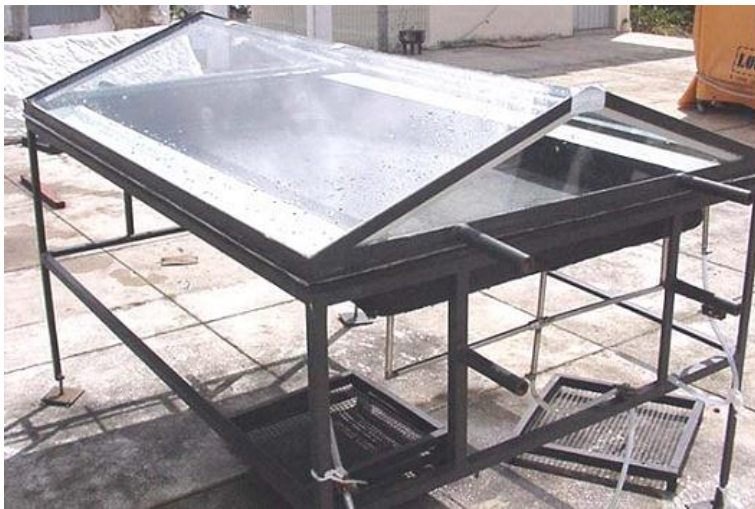
Figura 2.8 – Destilador solar com cobertura de 20° Fonte: Bezerra et al., (2004).
