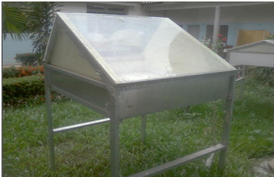
Figura 3.5 – Dessalinizador Solar Assimétrico Parabólico Composto (30° e 55°). Fonte:: Lopes (2013)
