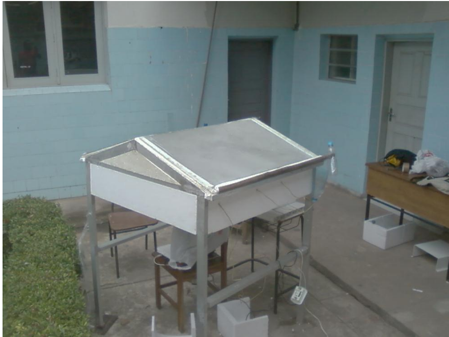
Figura 3.6 – Dessalinizador Solar Simétrico Parabólico Composto ( 20^\circ e 20^\circ ). Fonte:: Lopes (2013)
