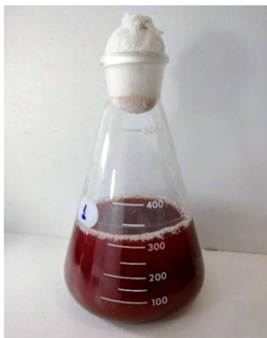
Figura 4.3. Fotofermentação realizada com a co-cultura ( R. rubrum : R. capsulatus ) inoculada no efluente sintético.
