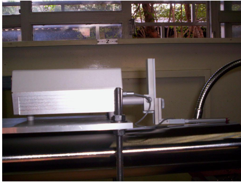
Figura 3.5 – Medição da rugosidade utilizando um rugosímetro digital
